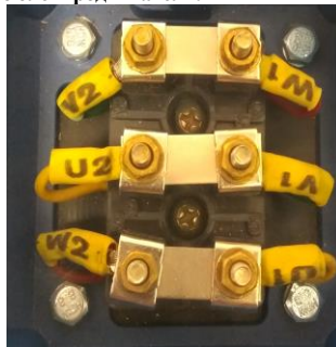
Рис.4. Соединение обмоток мотора по схеме «треугольник»
