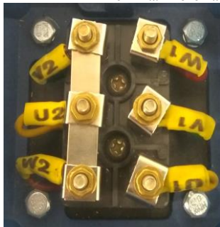
Рис.3. Соединение обмоток мотора по схеме «звезда»
