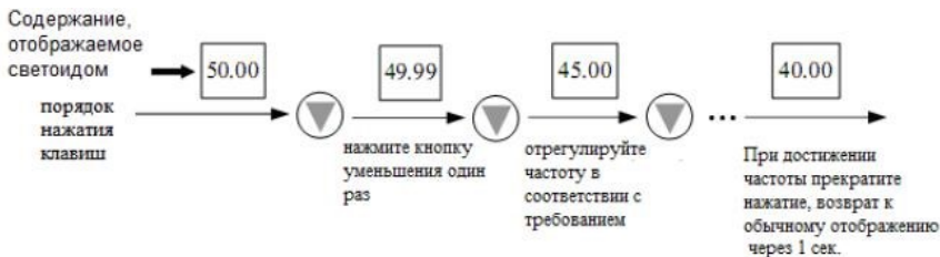
Рис. 4-8 Пример регулировки установленной частоты
