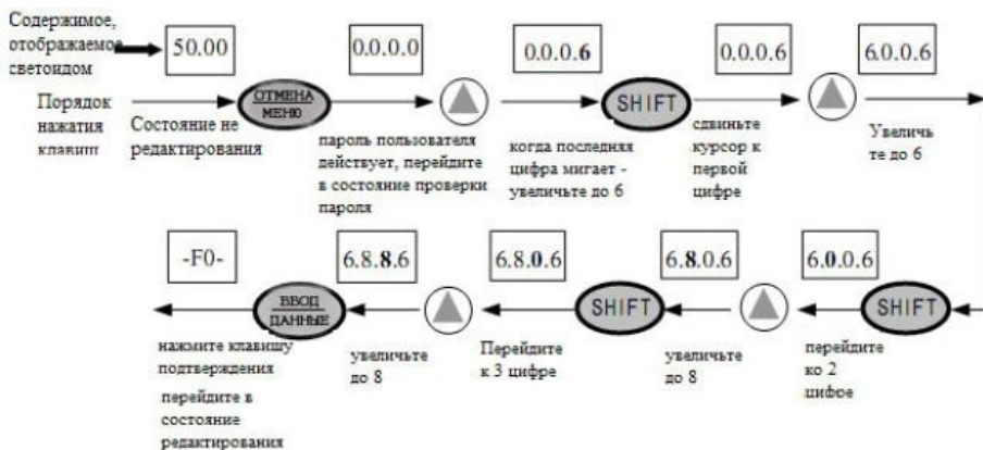
Рис. 4-10 ввод пароля для перехода к функционированию функционального кода
