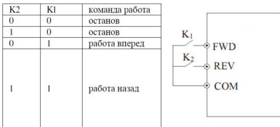
Рис. 6-28 2-проводной режим работы 2 2:
