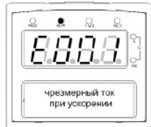
Рис. 4.3 Поддача питания, режим ожидания, рабочие показатели дисплея (3) Состояние отображения сигнала тревоги
