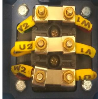
Рис.4. Соединение обмоток мотора по схеме «треугольник»
