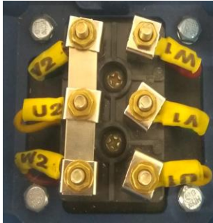
Рис.3. Соединение обмоток мотора по схеме «звезда»
